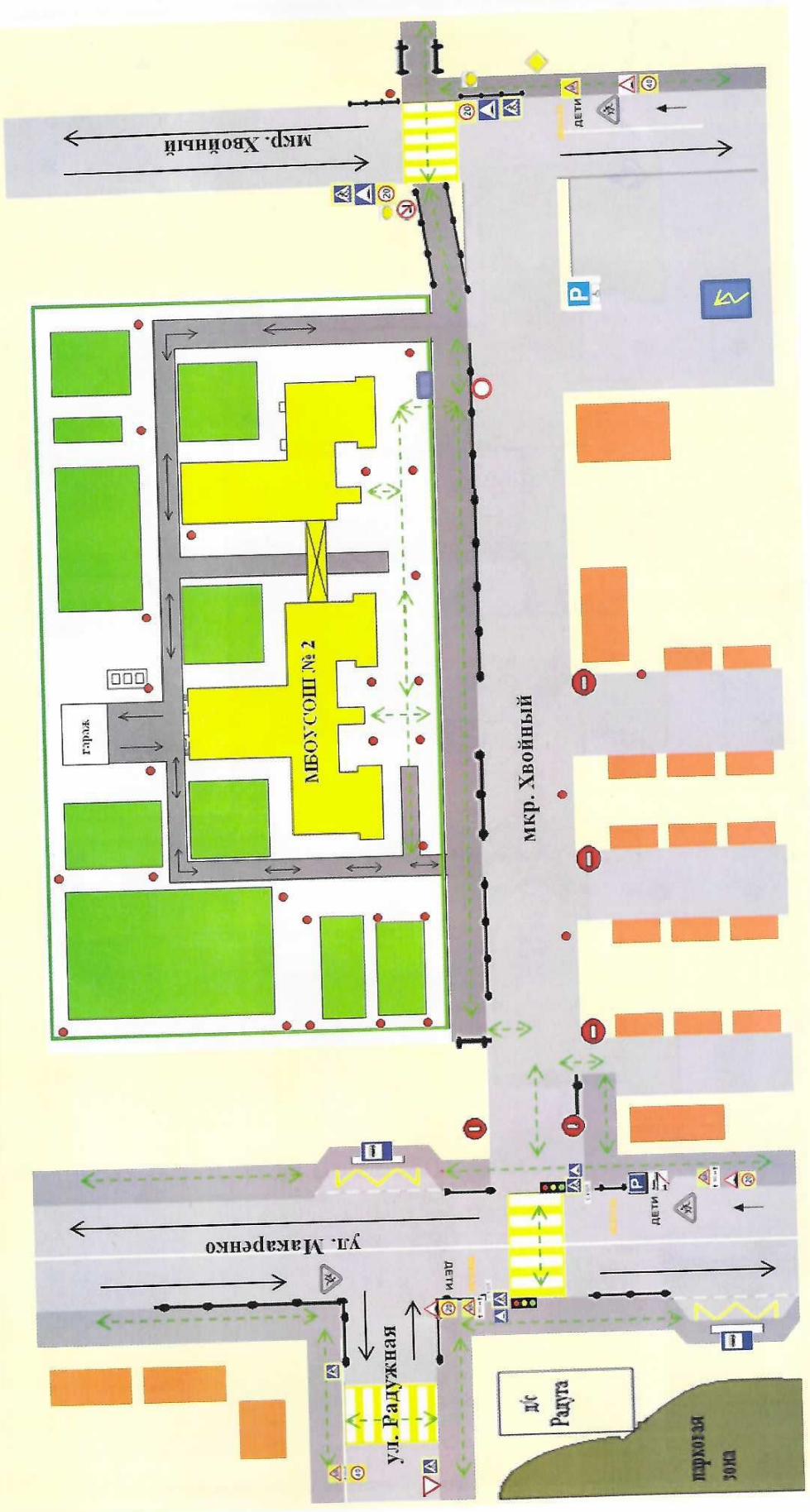
2. Схема организации дорожного движения в непосредственной близости от образовательного учреждения с разведением транспортных средств и расположением парковочных мест.
